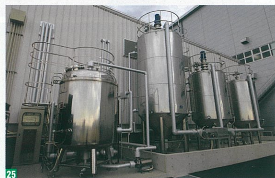
25 ローリー車で運ばれた油脂を工場内に自動供給する設備。 今年4月に稼働した
